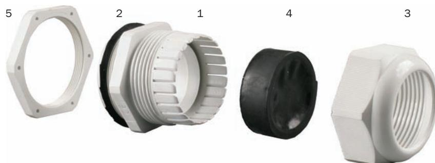
Сальник состоит из корпуса (1), уплотнителя (2), гайки уплотнения (3), прокладки (4) и фиксирующей гайки (5). Уплотнитель и прокладка выполнены из неопрена.
