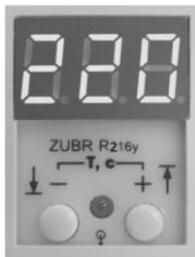
При включении устройства сразу начинает отображать значение напряжения сети. Если напряжение находится в допустимых пределах, включается нагрузка, и начинает светиться зеленый светодиод. Если напряжение сети превышает верхний предел или ниже нижнего предела, тогда напряжение на нагрузку не подается.
