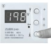
Для просмотра и изменения нижнего предела нажмите на кнопку «-». В этом состоянии кнопками «+» и «-» можно изменить нижний предел. Через 3 с после последнего нажатия кнопок, ZUBR вернется к индикации напряжения сети.
