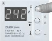
Для просмотра и изменения верхнего предела нажмите на кнопку «+». В этом состоянии кнопками «+» и «-» можно изменить верхний предел. Через 3 с после последнего нажатия кнопок, ZUBR вернется к индикации напряжения сети.
