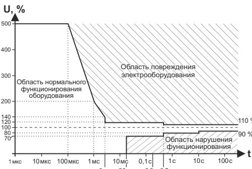
Рис. 1. Кривая работы электрооборудования ITIC (CBEMA), ([http://www.home.agilent.com/upload/cmc\\_upload/All/1.pdf?&cc=UA&lc=eng](http://www.home.agilent.com/upload/cmc_upload/All/1.pdf?&cc=UA&lc=eng)).
