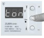
Второе кратковременное нажатие средней кнопки отобразит на индикаторе «ton». При отпускании мигающее значение времени задержки включения нагрузки можно изменить кнопками «+» или «-». Время задержки можно менять от 3 до 600 с, шаг изменения 3 с. Через 3 с происходит возвращение к индикации напряжения сети.
