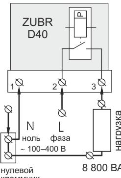
Схема 1. Упрощенная внутренняя схема и схема подключения
