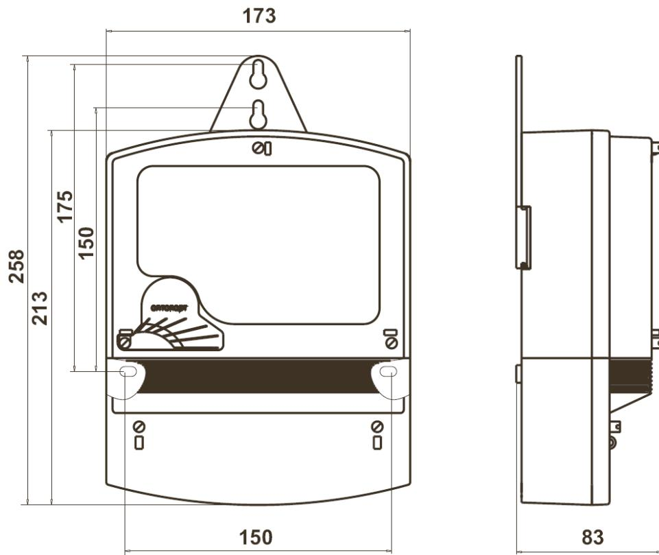
**Рисунок 2 - Габаритные и установочные размеры счетчика**
