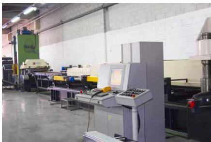
Линия по производству металлических листовых лотков
