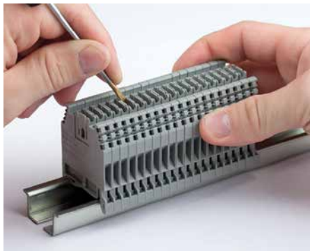
2. Возьмите отвертку и надавите на перемычку, опустив ее до упора
