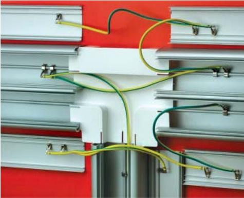
Проводами (код E0001BC) соедините основание одного из коробов 140x50 с его крышками. Рекомендуем устанавливать клеммы провода (E0001BC) на дно короба на расстоянии 16 см от клемм провода (E0001B). Вторые клеммы провода (E0001BC) защелкиваются на направляющие на внутренних сторонах крышек. Затем проводами (код E0001C) соедините крышки всех коробов.
