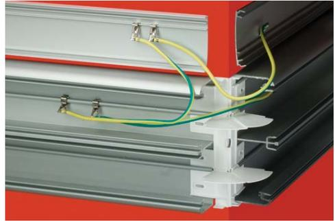
Проводом заземления (код E0001C) соедините крышки разных коробов. Клеммы провода (код E0001BC) установите защелкиванием на направляющие на внутренней стороне крышек.
