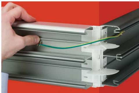
Клеммы провода заземления (код E0001B) установите защелкиванием на направляющие, расположенные на дне оснований коробов, соединив проводом один алюминиевый кабельный канал с другим.
