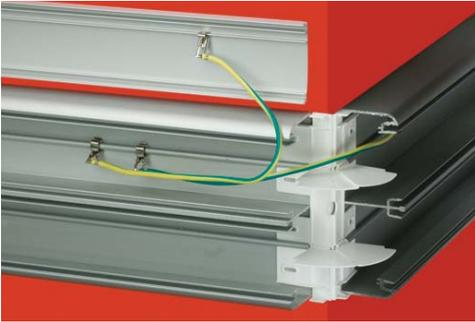
Проводом (код E0001BC) соедините основание одного из коробов с его крышкой. Рекомендуем устанавливать клемму провода (код E0001BC) на дно короба на расстоянии 16 см от клеммы провода (код E0001B). Вторую клемму провода (код E0001BC) установите на крышку.
