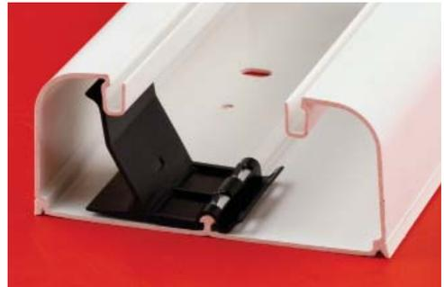
Держатель кабеля заводится внутрь короба и устанавливается защелкиванием на направляющую, которая расположена на дне основания короба (см. фото). Затем прокладываются кабели. Один ряд фиксаторов делит короб на 2 секции. А если установить ещё один ряд фиксаторов, развернув их на 180°, то короб будет разделён на 3 секции (1 центральную и 2 по бокам)
