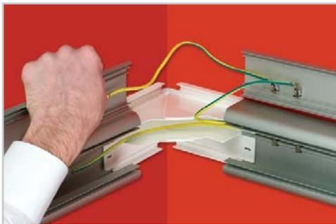
Проводом (код E0001BC) соедините основание одного из коробов с его крышкой. Одна из клемм защелкивается на направляющую на дне короба. Рекомендуем устанавливать клемму провода (код E0001BC) на расстоянии 16 см от клеммы провода (код E0001B). Вторая клемма (код E0001BC) защелкивается на направляющую на внутренней стороне крышки. Проводом (код E0001C) соедините крышки разных коробов.
