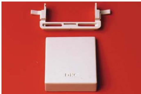
Для монтажа коробки над миниканалами сечением 40x17 и 50x20 используется адаптер (код 10046, см. на фото). Для монтажа с миниканалом 40x17 – обрежьте лапки адаптера
