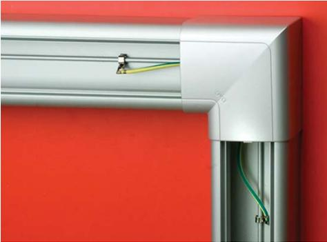
Клеммы провода заземления (код E0001B) установите защелкиванием на направляющие на дне оснований коробов, соединив один алюминиевый кабель-канал с другим.
