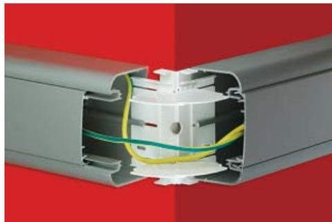
Проводом (код E0001BC) соедините основание одного из коробов с его крышкой. Рекомендуем устанавливать клемму провода (код E0001BC) на расстоянии 16 см от клеммы провода (код E0001B). Вторая клемма провода (код E0001BC) защелкивается на направляющую на внутренней стороне крышки. Далее проводом (код E0001C) соедините крышки разных коробов.
