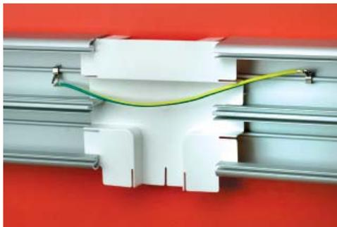
Просверлите на дне коробов отверстия под крепёж. Установите короба на стене, вставив между ними внутреннюю базу тройника. Для монтажа рекомендуем использовать на выбор крепёж ДКС: код 06541, 06542, 06551 или 06552.
