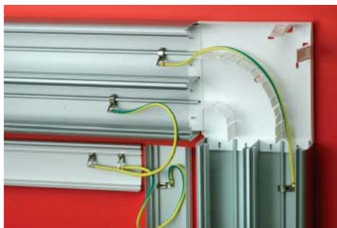
Клеммы провода заземления (код E0001B) установите зашелкиванием на направляющие на дне оснований коробов, соединив один алюминиевый кабель-канал с другим.
