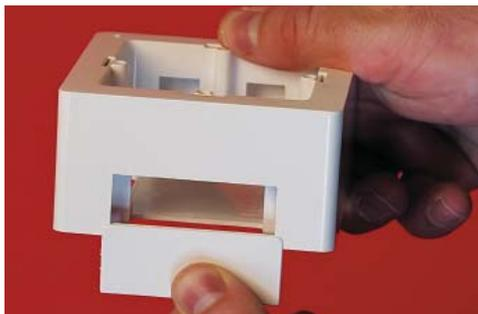
Если подвод кабелей будет не в миниканале, а с помощью гофрированных труб (например, в штрабе при скрытой проводке), то необходимо установить заглушки в коробку с 3-х сторон. Заглушки устанавливаются до того, как коробка будет установлена на стену
