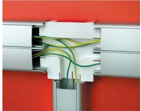
Защелкиванием установите крышки на основания коробов, отступив от края (торца) каждого короба по 3 см или более.
