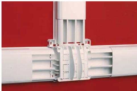
Вставьте в базу тройника отводимый короб. Используйте разделитель тройника для отвода проводки под углом 90°. Удалите ненужные участки преперфорации
