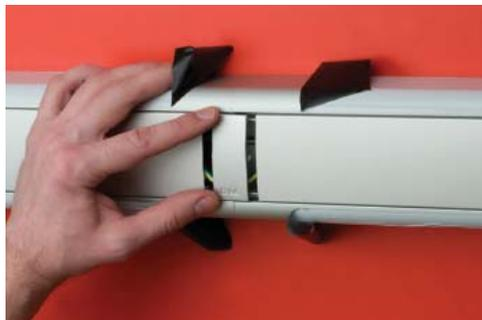
Защёлкиванием установите крышки на основания коробов так, чтобы между ними было расстояние 3 см. Затем защёлкиванием установите накладку на стык.
