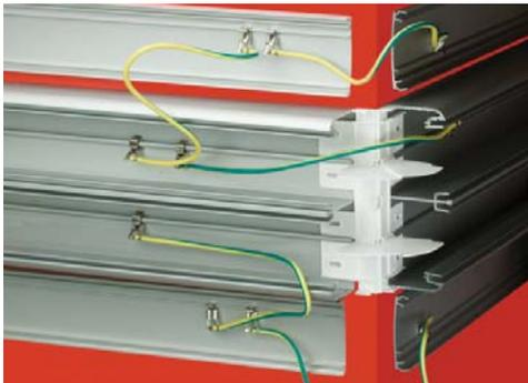
Проводом (E0001BC) соедините основание короба с его крышкой. Одна из клемм провода (код E0001BC) защелкивается внутри крышки. Проводом (код E0001C) соедините крышки.
