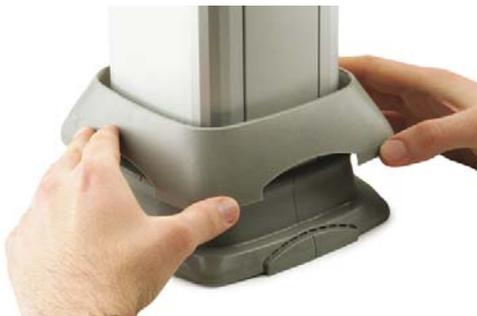
После крепления базы к поверхности пола и подведения электропроводки установите 2 внутренние накладки, вставляя их в базу колонны в спец. металлические направляющие.
