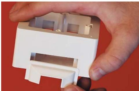
Для ввода в коробку миниканалов 22x10, 30x10, 15x17, 25x17 и 40x17 мм – используйте соответствующий адаптер, установив его в проем коробки до того, как прикрепить коробку к стене (адаптеры поставляются с коробкой). Миниканал 50x20 мм вводится в проем коробки без адаптера
