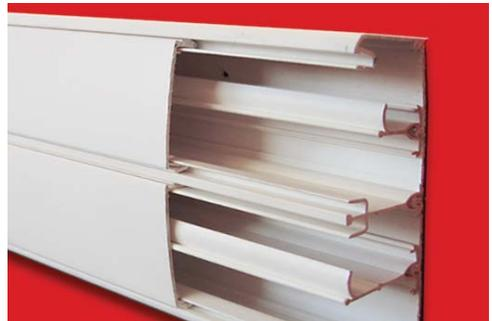
На основание короба 140x50 мм (код 01400) можно установить по центру несущий разделитель (код 01412), а затем установить 2 крышки шириной по 60 мм (код 09510). Получается электроустановочный короб (2 отсека). Внутри каждого отсека можно установить разделители (перегородки; код 01415 - см. на фото в нижнем отсеке; код 09514 - см. на фото в верхнем отсеке). Получается электроустановочный короб с 4-мя отсеками
