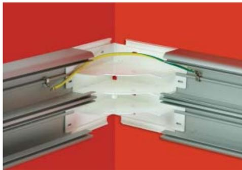
Клеммы провода заземления (код E0001B) установите защелкиванием на направляющие, расположенные на дне оснований коробов, соединив проводом оба короба.
